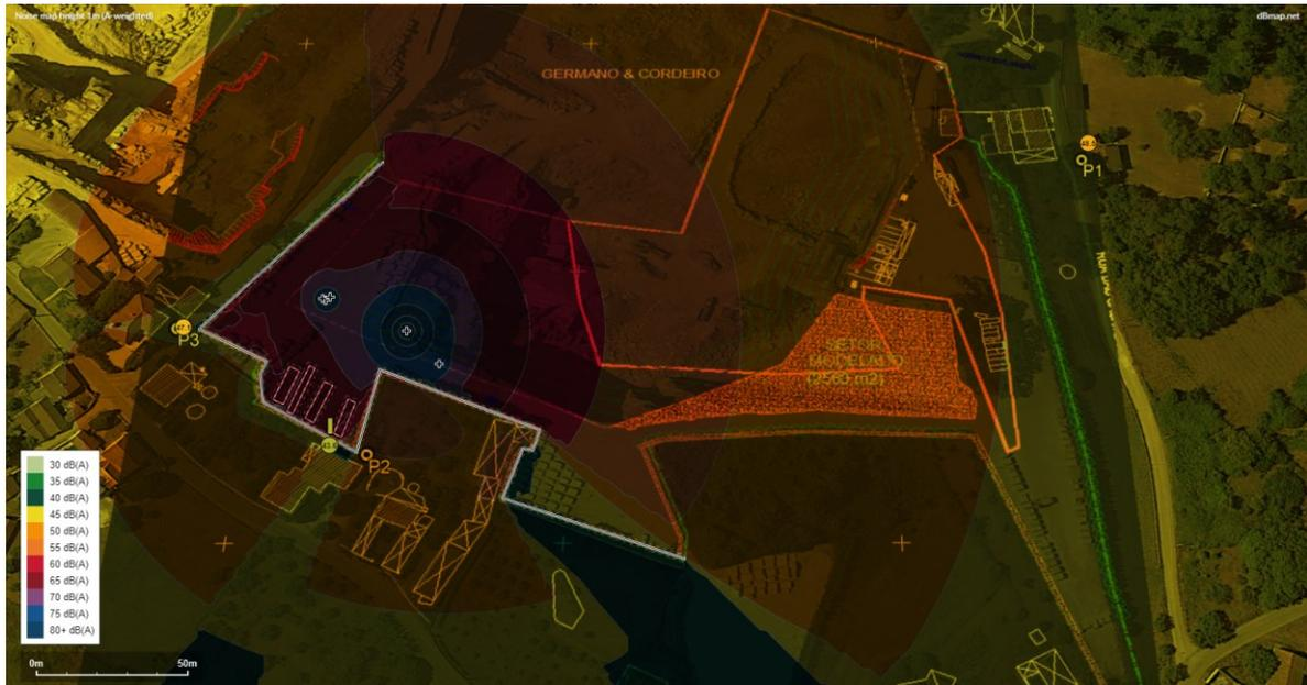
Fig. 10.1.3. – Lava próxima de P3: perfis das linhas isófonas do ruído particular geradas pelas fontes mais ruidosas a operarem à cota zero
