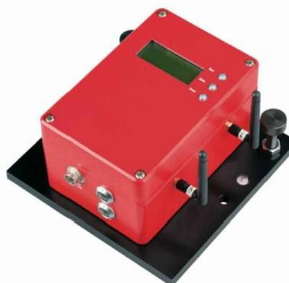
Figura 16 – Sismógrafo
