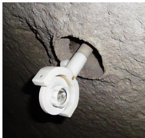
Figura 15 – Prisma de convergência
