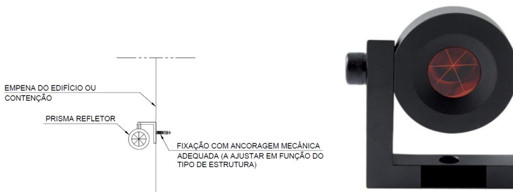
Figura 2 – Prisma topográfico para edifícios e contenções
