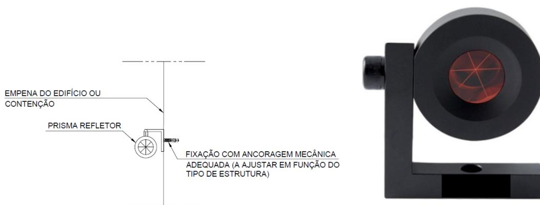
Figura 2 – Prisma topográfico para edifícios e contenções.
