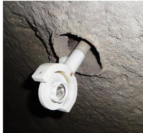
Figura 15 – Prisma de convergência
