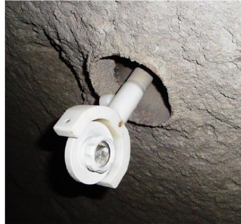
Figura 7 – Prisma de convergência.
