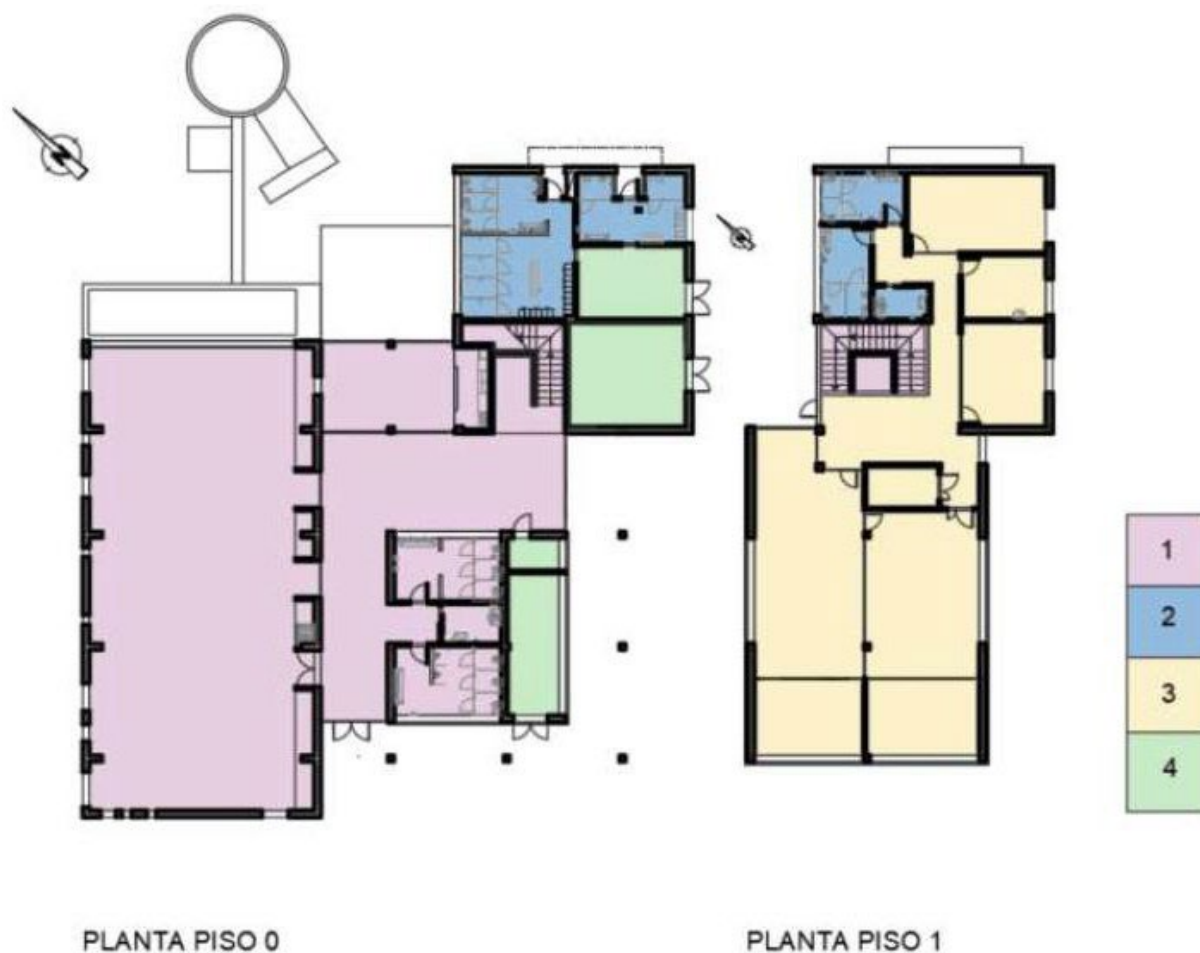
Ilustração 25. Planta de pavimentos do edifício de exploração
