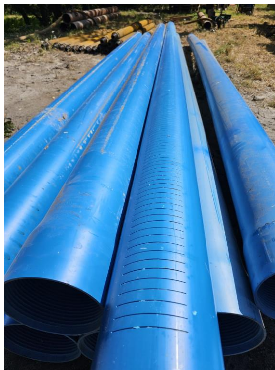
Fotografia 9 e 10 – Caudal registado no final dos trabalhos de perfuração (8000 L/h); Coluna de revestimento de pvc georoscado reforçado de 160mm.
