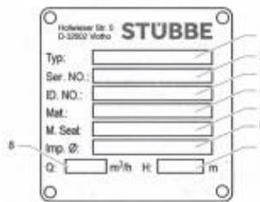
Fig. 1 Placa de características (ejemplo)
