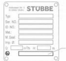
Fig. 2 Placa de características ATEX (ejemplo)
