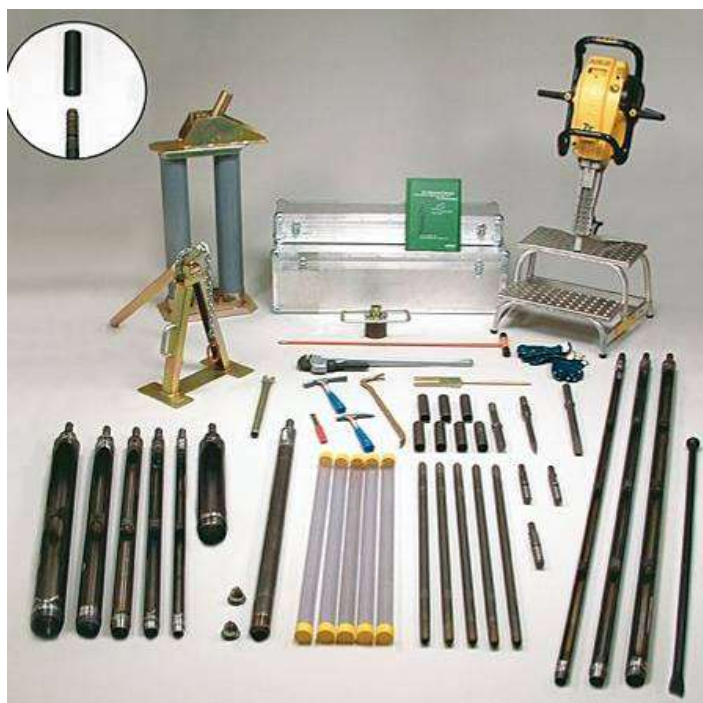
Figura 3 – Equipamento de recolha de solos à percussão.
