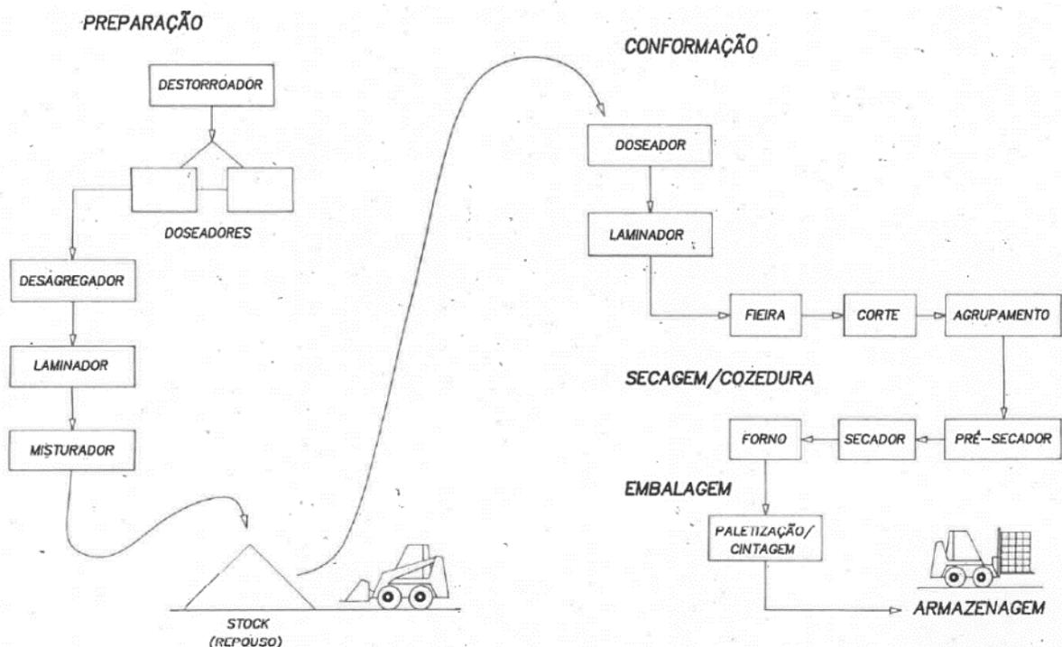
Fig. 2 - Fluxograma do processo produtivo da Cerâmica Outeiro do Seixo
