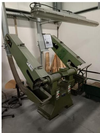
**Figura 12.** Unidade de lixagem/polimento de cabeça dupla
