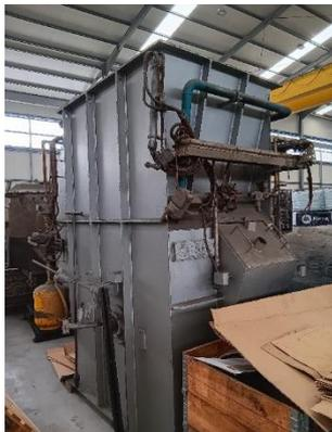
Módulo inferior (fusão e manutenção do alumínio fundido)
