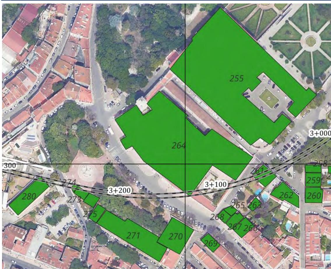
Figura 8: Destaque das previsões do Anexo I na zona do Palácio das Necessidade (km 3+000 a km 3+300; v_{ef} \leq 0.02 mm/s)
