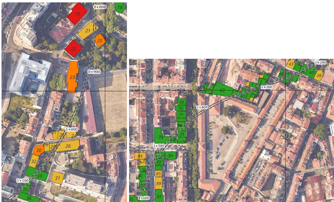
Figura 5: Destaque dos edifícios onde se prevê incumprimento dos limites de ruído re-radiado ( v_{ef} > 0.02 mm/s; edifícios numerados não a verde; km 0+800 a km 1+600)
