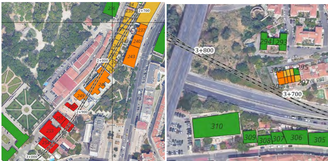
Figura 7: Destaque dos edifícios onde se prevê incumprimento dos limites de ruído re-radiado ( v_{ef} > 0.02 mm/s; edifícios numerados não a verde; km 2+700 a km 3+000 e 3+700 a km 3+800)
