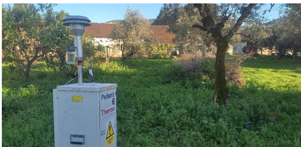
Figura 2 - Amostrador sequencial usado no ponto de medição a Sul (S) da pedreira
