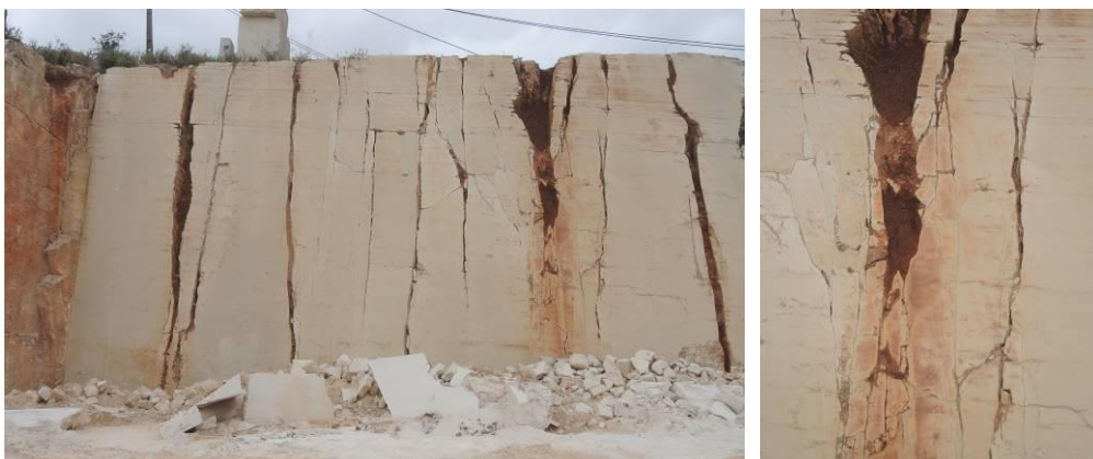
Foto 10 e 11 – Corte de uma bancada, onde se observam diáclases estreitas e profundas, e pormenor de uma diáclase preenchida com terra rossa.
