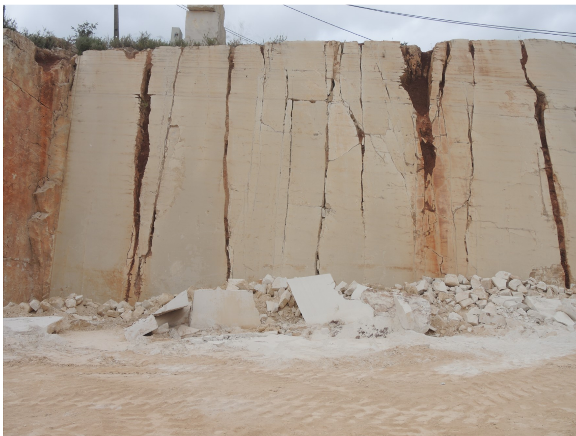
Fot. 10 – Corte de uma bancada onde se observam diáclases estreitas e profundas.
