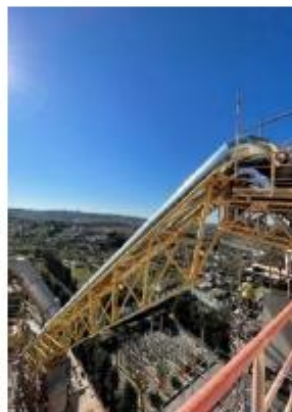
Exemplos de medidas implementadas nos últimos anos para a redução das entradas de ar falso e para a estabilidade do processo de produção de clínquer no forno 3: substituição do casing do electrofiltro (à esquerda), substituição de condutas na alimentação de combustíveis alternativos ao pré-calcinador (ao centro) e modificação da conduta ascendente "riser duct" (à direita).
