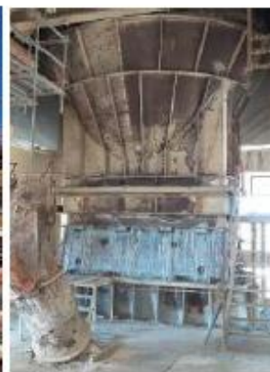
Exemplos de medidas implementadas nos últimos anos para a redução das entradas de ar falso e para a estabilidade do processo de produção de clínquer no forno 3: substituição do casing do electrofiltro (à esquerda), substituição de condutas na alimentação de combustíveis alternativos ao pré-calcinador (ao centro) e modificação da conduta ascendente "riser duct" (à direita).
