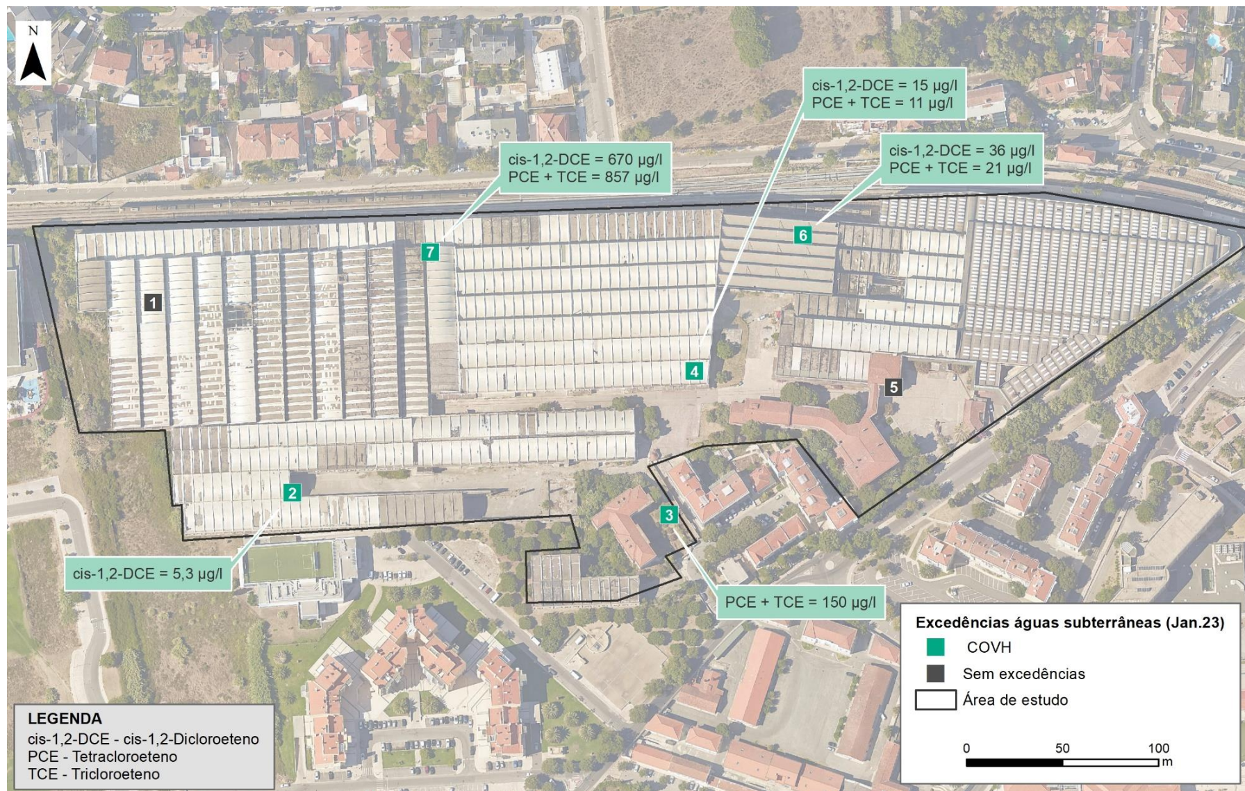
Figura 7.2 – Excedências aos VR/LNQ nas águas subterrâneas – janeiro 2023
