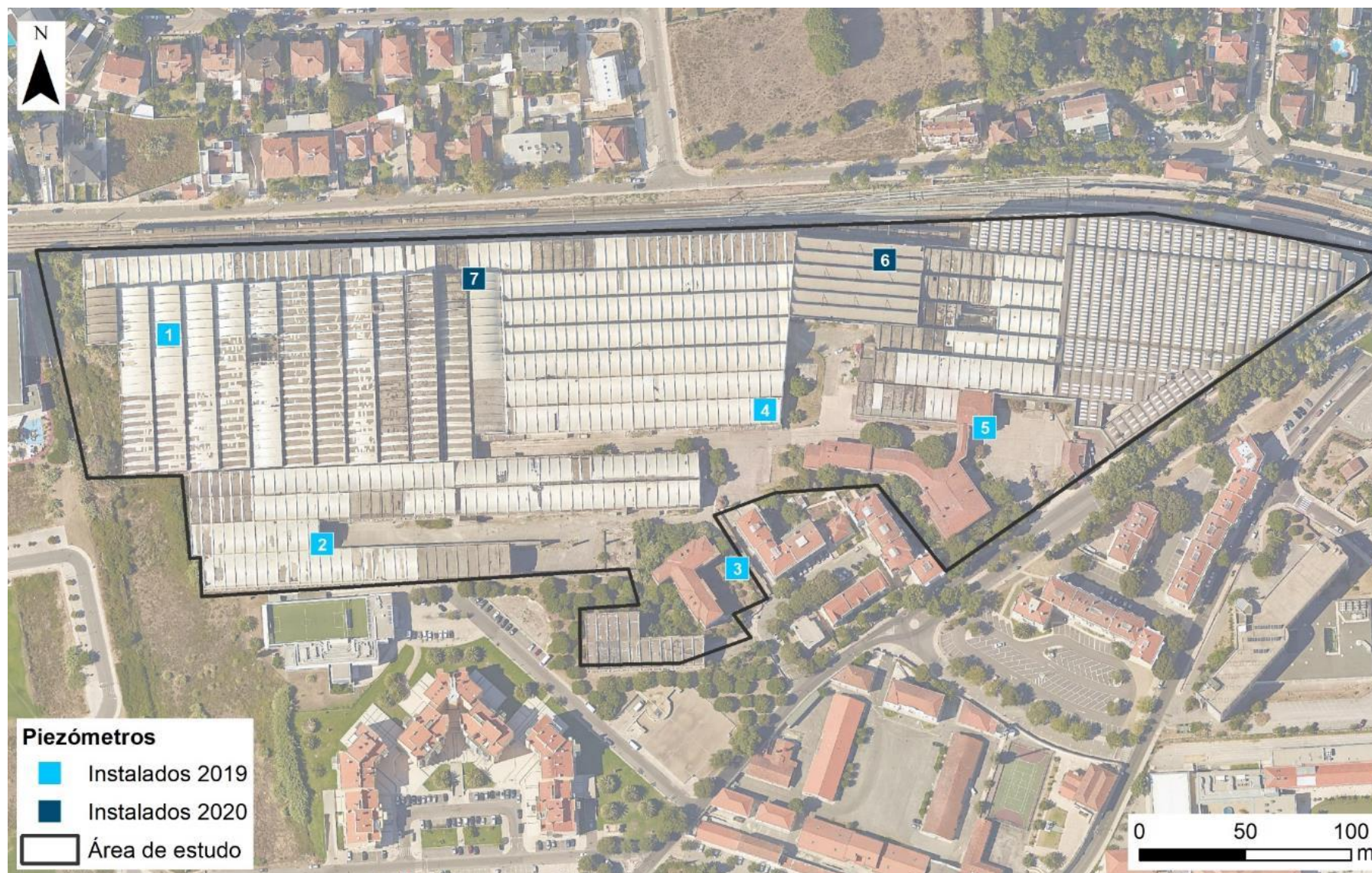
Figura 4.4 – Piezómetros instalados (campanha de janeiro de 2020)
