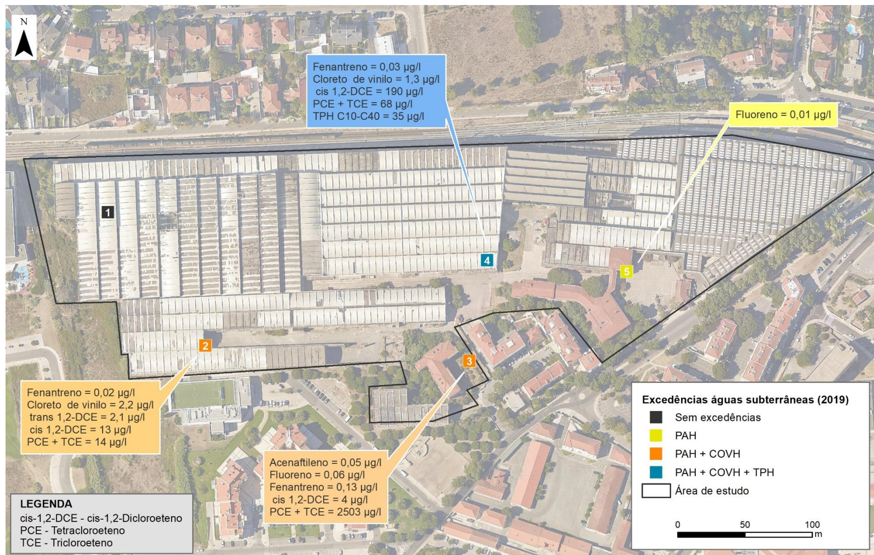
Figura 7.3 – Excedências aos VR/LNQ nas águas subterrâneas – 2019
