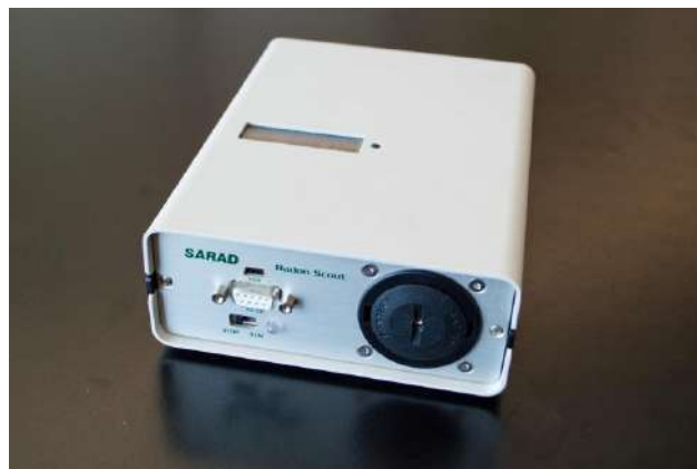
Figura 10 – Equipamento de medição da concentração de gás radão no ar interior de edifícios (Radon Scout Pro).
