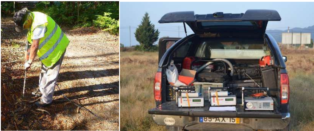
Figura 9 – Medição da concentração de gás radão através de perfuração prévia do solo com equipamento apropriado (à esquerda) e uso de equipamentos equipados com câmara de ionização sensível à radiação alfa (à direita).
