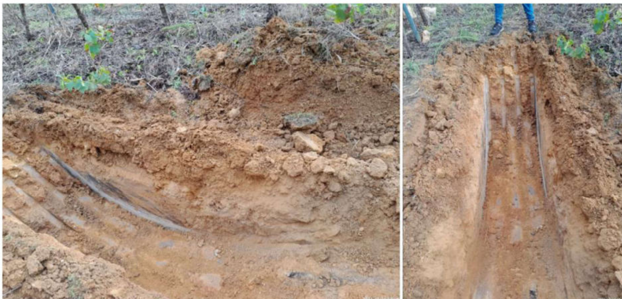
Figura 22 – Aspeto geral do poço P10 (poço que atingiu a menor profundidade – 0,90 m)
