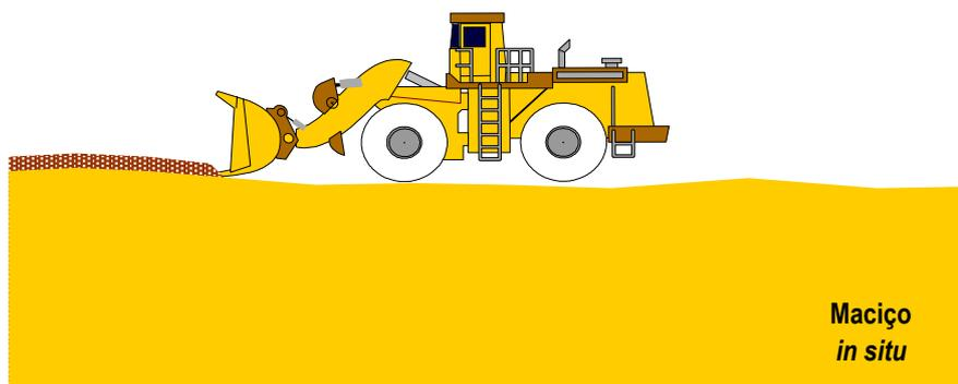
Figura II.3 – Técnica de remoção da terra vegetal.
