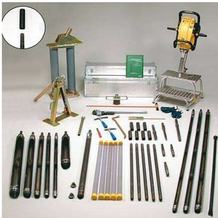
Figura 4 – Equipamento de recolha de solos à percussão.
