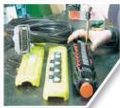
Cableado de balonera Pendant control wiring
