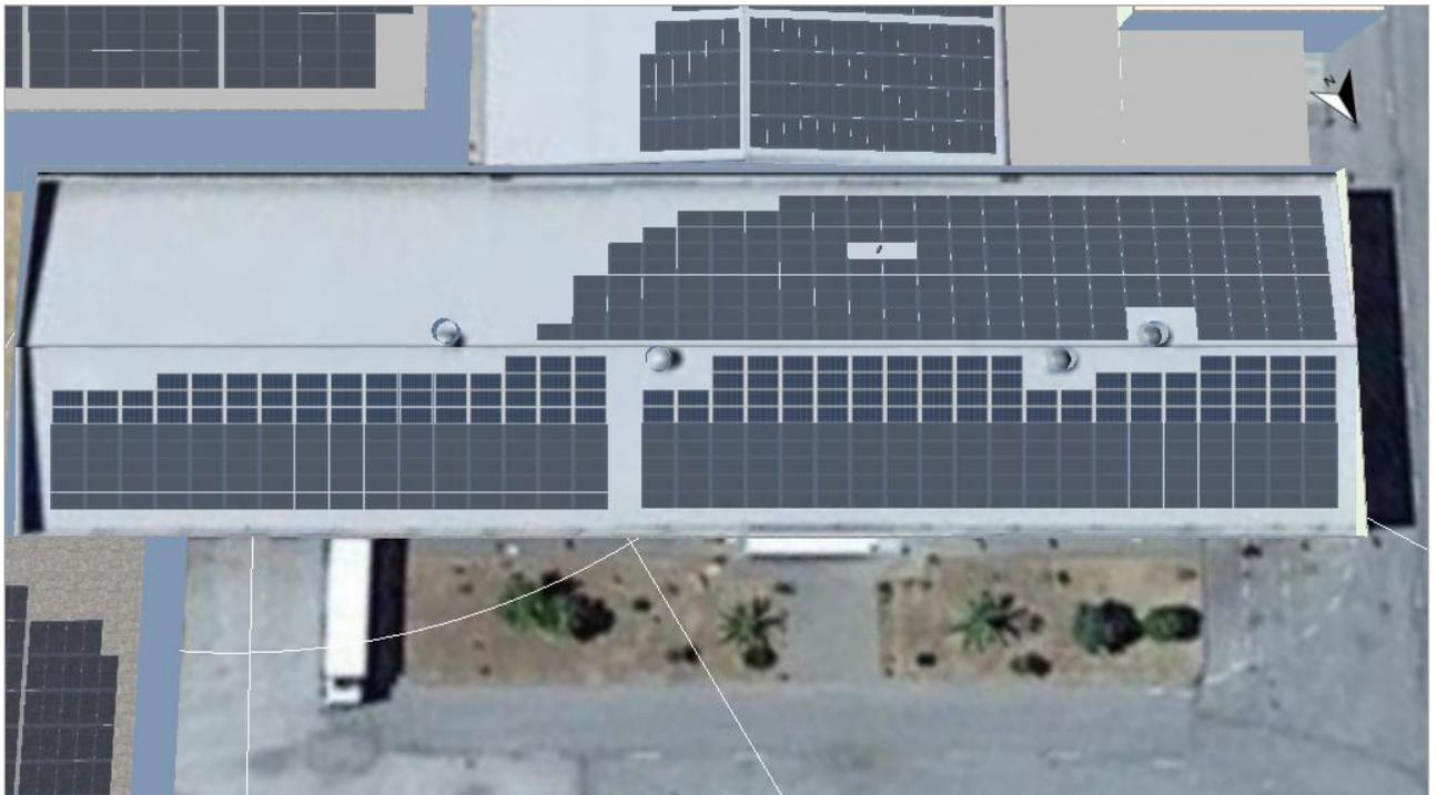
Figura: 21. Área do módulo - Edifício 02-Água Nordeste
