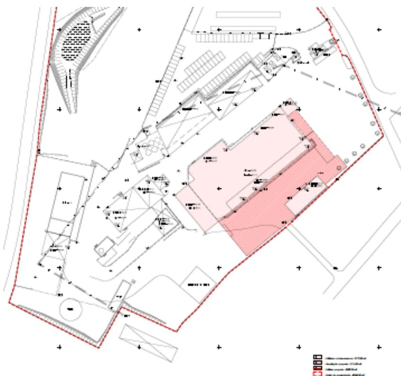
O projeto de ampliação prevê as seguintes intervenções: construção/ampliação da sala de desmancha; construção/ampliação de instalações de lavagem de caixa PVC; construção/ampliação de sanitários e balneários, esta alteração não implica um aumento superior a 30 % da capacidade produtiva existente ou a 30 % da área edificada ou do estabelecimento industrial.
