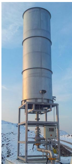
Figura 38. Exemplo de uma tocha para volumes elevados ( >3000 \text{ Nm}^3/\text{h} ).
