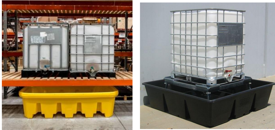
Figura 49. Exemplos de recipientes de contenção para IBC's.
