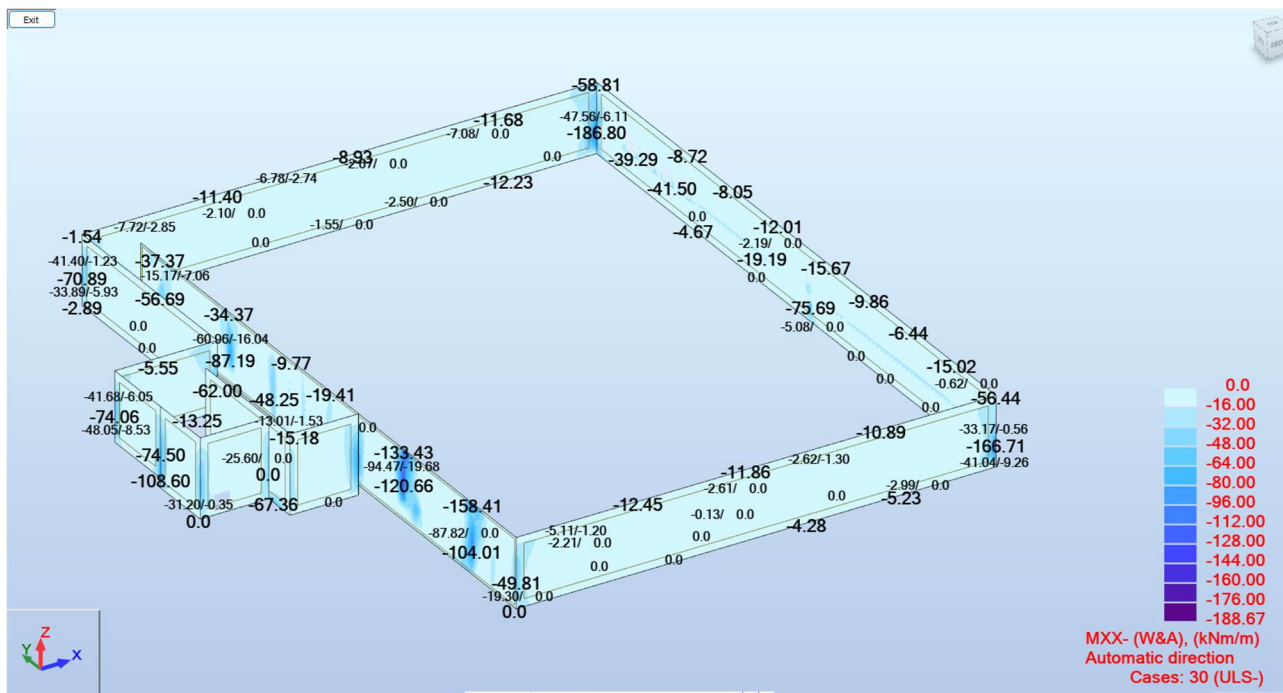
Ilustração 26 - Mapa de momentos M_{xx} para dimensionamento de armadura inferior
