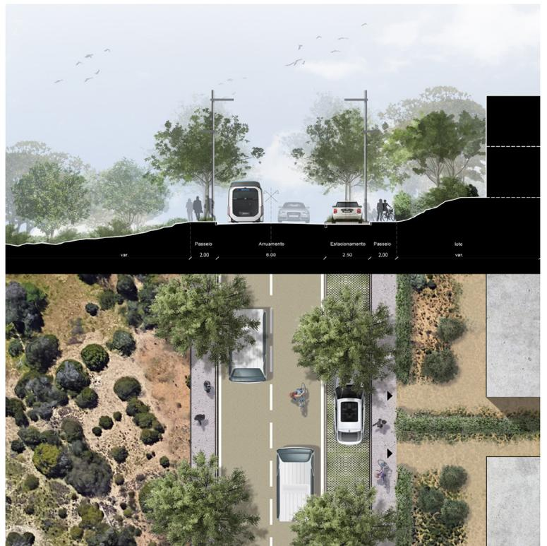
Figura 7 – Planta e Corte ilustrados de zonas de barreira visual
