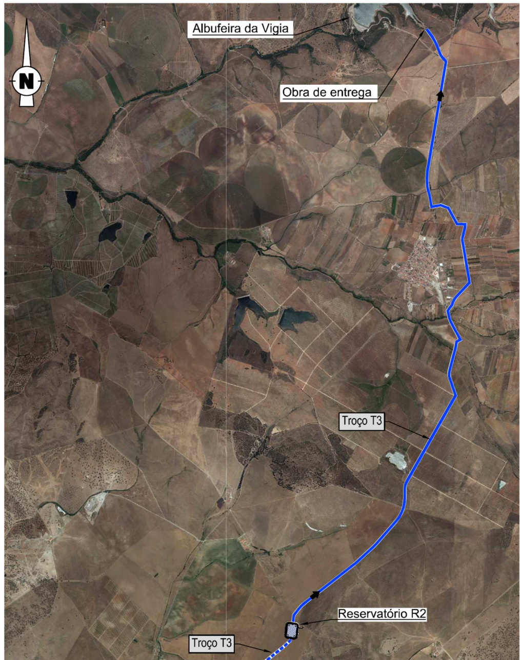
Figura 3.1 – Implantação sobre ortofotomapas da conduta adutora T3.
