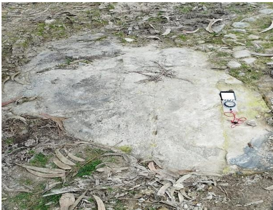
Figura 29 – Observação de afloramento granítico a sul da área, pouco alterado W2 e pouco fraturado F2: estação geológica #5.
