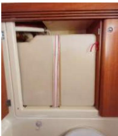
**Fotografia 8** - Tanque de Águas Cinzentas a Bordo de Embarcação
