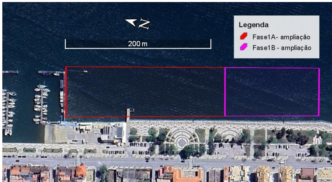
FIG. 7 - Faseamento da construção da ampliação do PRG
