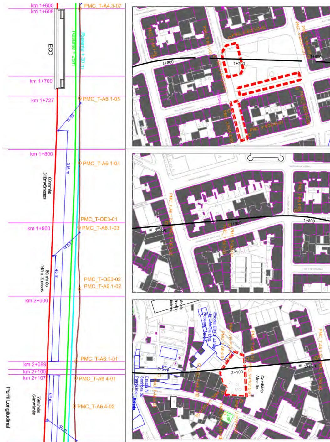
**Figura 13: Perfil longitudinal e Plantas, com localização dos Pontos de Monitorização Contínua associados à frente de túnel A6.1 e OE3**
