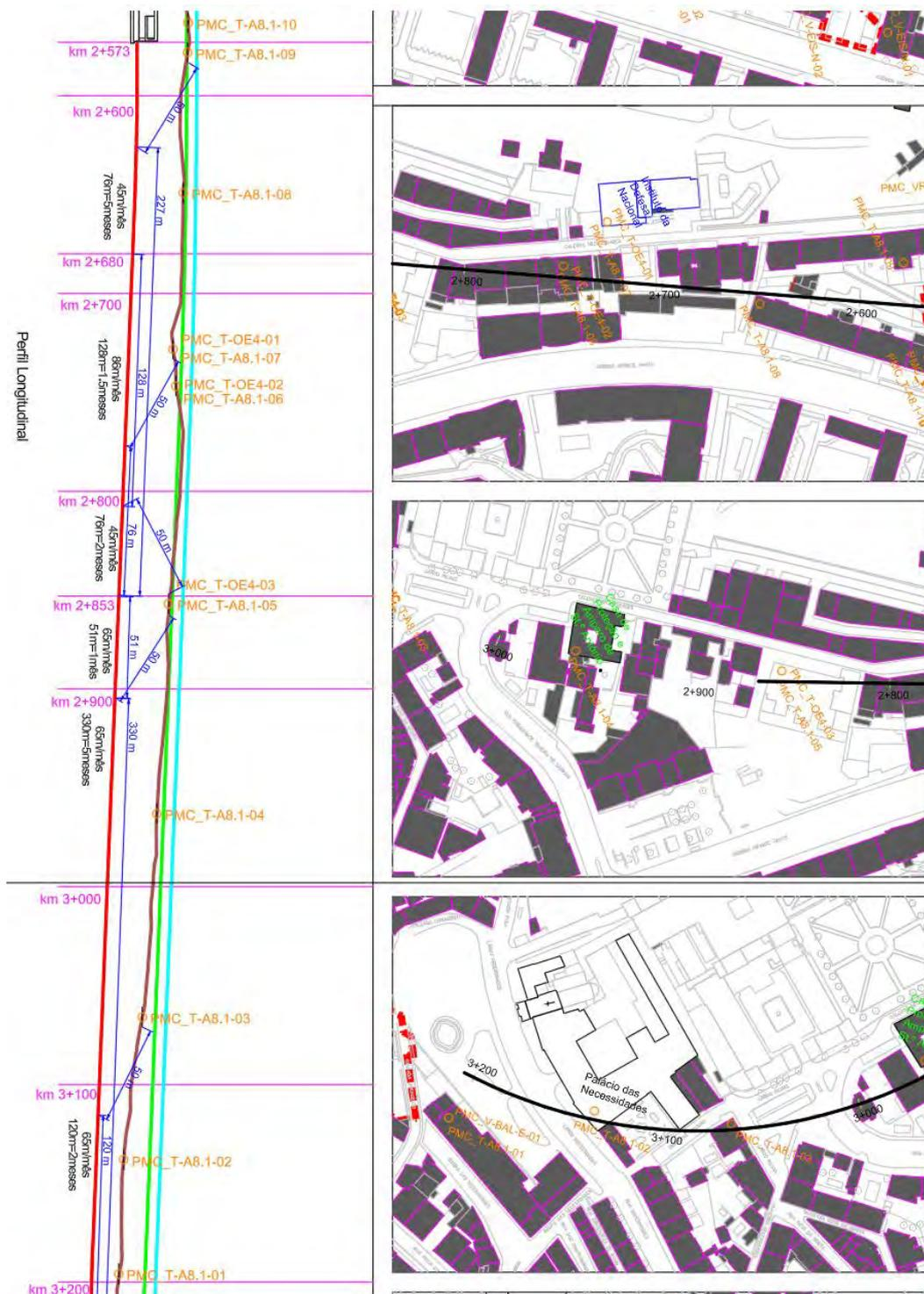
Figura 15: Perfil longitudinal e Plantas, com localização dos Pontos de Monitorização Contínua associados à frente de túnel A8.1 e OE4
