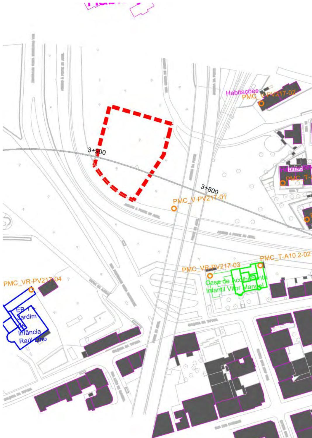
**Figura 9: Localização do Estaleiro PV217 e envolvente, e identificação dos pontos de monitorização na fase de construção, vibração (PMC\_V) e vibração e ruído (PMC\_VR) propostos**
