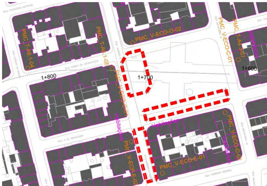
Figura 4: Localização dos Estaleiros ECO-C, ECO-E e ECO-O e envoltório, e identificação dos pontos de monitorização na fase de construção, vibração (PMC\_V) propostos
