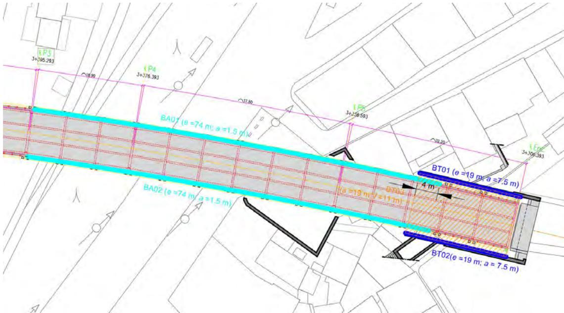
Figura 1: Esquema em planta de implantação das Barreiras Acústicas (BA01 e BA02) e do Material Absorvente Sonoro na Boca do Túnel (BT01, BT02 e BT03)
