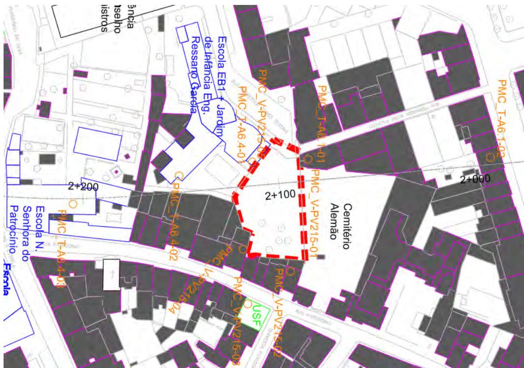
Figura 5: Localização do Estaleiro PV215 e envolvente, e identificação dos pontos de monitorização na fase de construção, vibração (PMC\_V) e vibração e ruído (PMC\_VR) propostos
