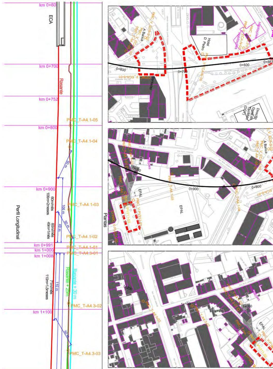
Figura 11: Perfil longitudinal e Planis, com localização dos Pontos de Monitorização Contínua associados à frente de túnel A4.1
