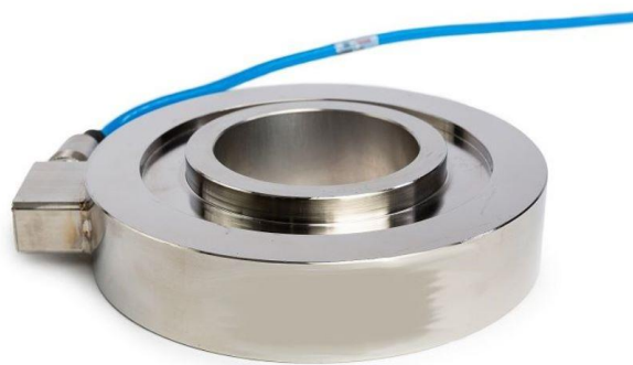
Figura 14 – Célula de carga em ancoragens
