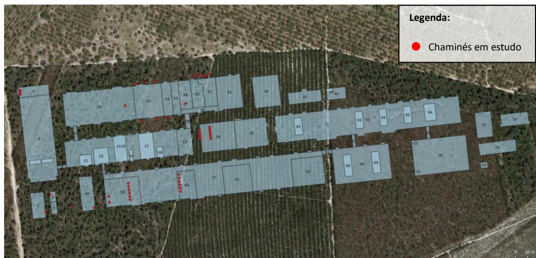
Figura 2.2 – Apresentação dos obstáculos inseridos no raio de 300 metros, a partir das fontes em estudo, com foco nos edifícios da própria instalação (Imagem do ano 2023 do Google Earth )
