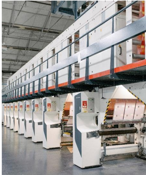
Figura 6 - Registo fotográfico de um equipamento de impressão por rotogravura
