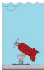
Instalación anclada al fondo del tanque
