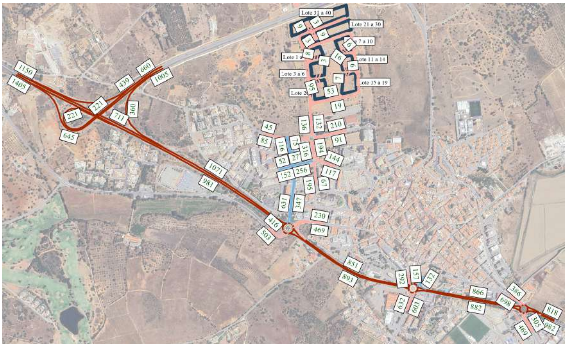
Figura 28 – Volumes de tráfego (macro modelo de tráfego em PTV Visum, HPM-DU, Ano Horizonte) (uvle/hora).
