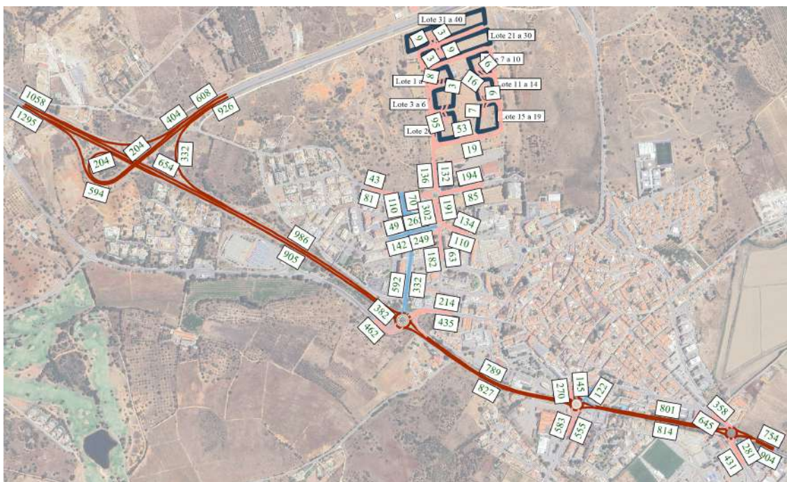
Figura 25 – Volumes de tráfego (macro modelo de tráfego em PTV Visum, HPM-DU, Ano Base) (uvle/hora).
