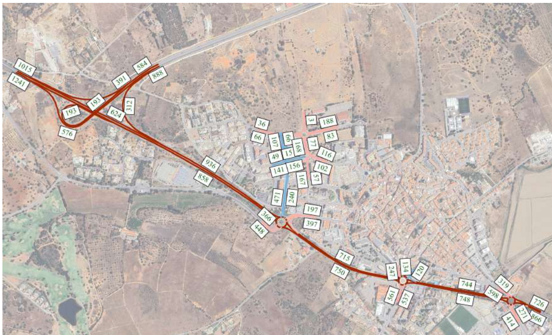
Figura 22 – Volumes de tráfego (macro modelo de tráfego em PTV Visum, HPM-DU, Atualidade) (uvle/hora).
