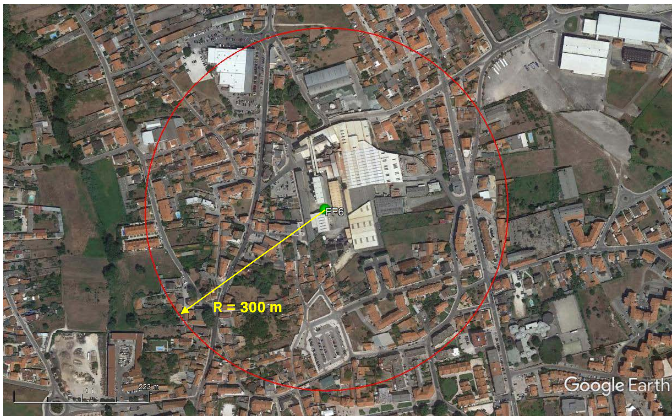
Figura 4 - Localização da chaminé e indicação de raio de 300 m em redor da chaminé em dimensionamento
