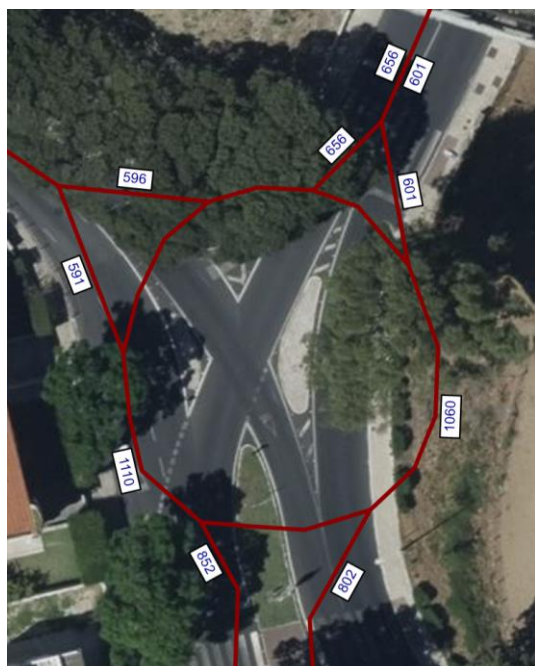
Figura 72 – Interseção 5, volumes em uvle na HPM-DU (futuro)
