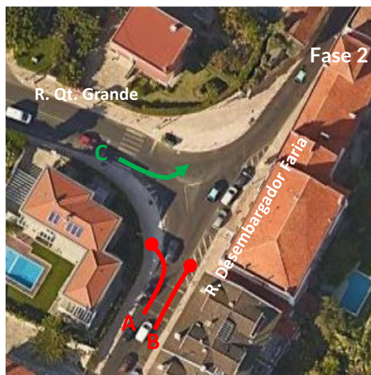
Figura 88 – Interseção 13, movimentos analisados no cenário atual (Fase 2)
