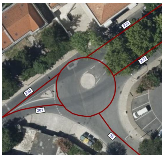
Figura 55 – Interseção 2, volumes em uvle na HPM-DU (futuro)
