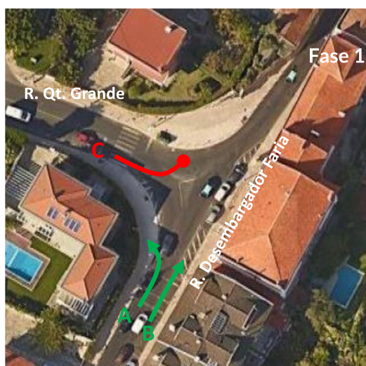
Figura 87 – Interseção 13, movimentos analisados no cenário atual (Fase 1)
