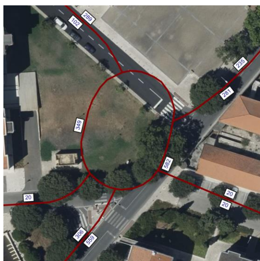
Figura 61 – Interseção 3, volumes em uvle na HPM-DU (futuro)
