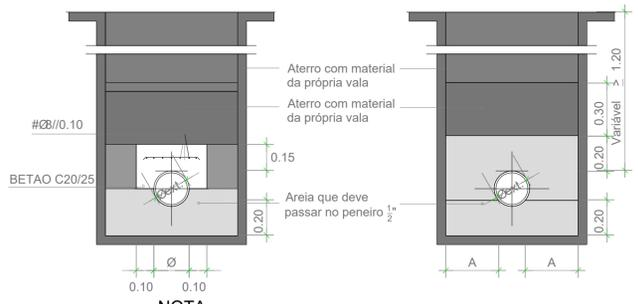
NOTA: A face inferior da vala será bem compactada (compactação superior a 85% do Ensaio Normal)
