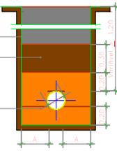
**NOTA:** A face inferior da vala será bem compactada (compactação superior a 65% do Ensaio Normal)
