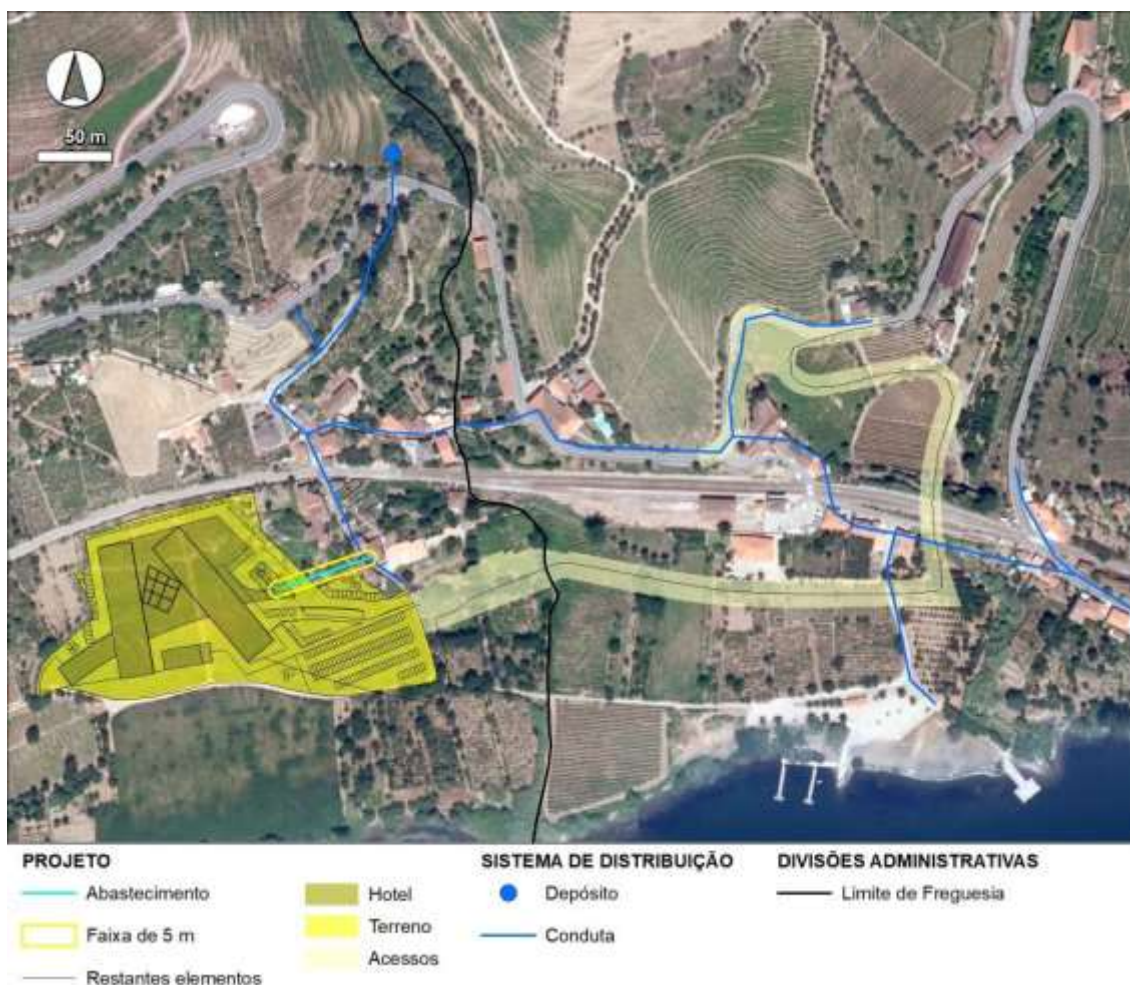
Figura 3.2.8 – Ligação prevista à rede pública de distribuição (Fonte: ARQ 2525 (2017), CMMF (comunicação escrita, janeiro de 2017), DGT/IFAP (2012))
