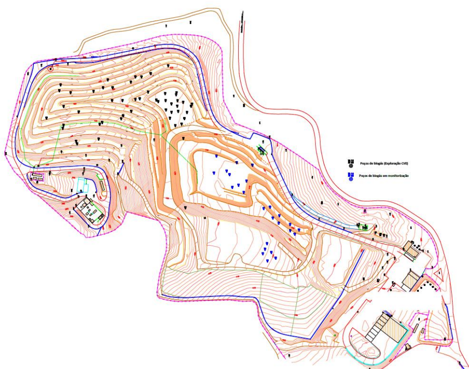
Figura 15 – Sistema Drenagem de Biogás do Aterro Sanitário de Urjais
