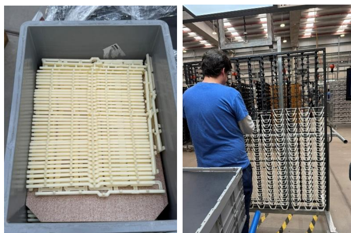
Figura 5. Peça plástica por pintar (foto à esquerda) e preparação do bastidor (foto à direita).
