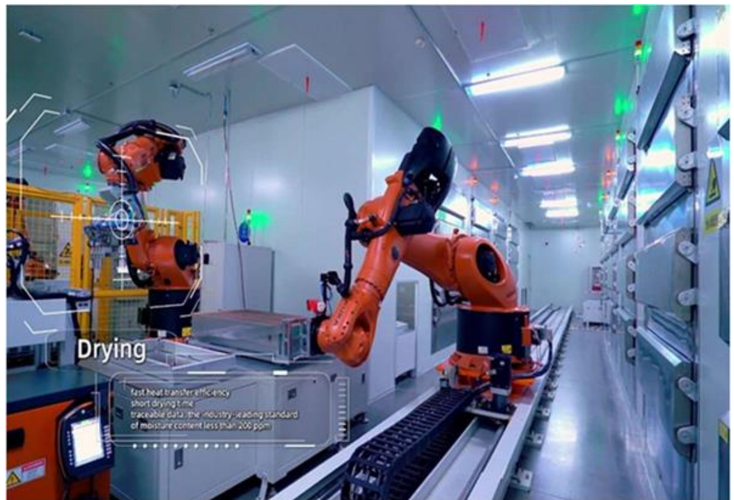
Figura 2.27 - Linha de secagem automática
