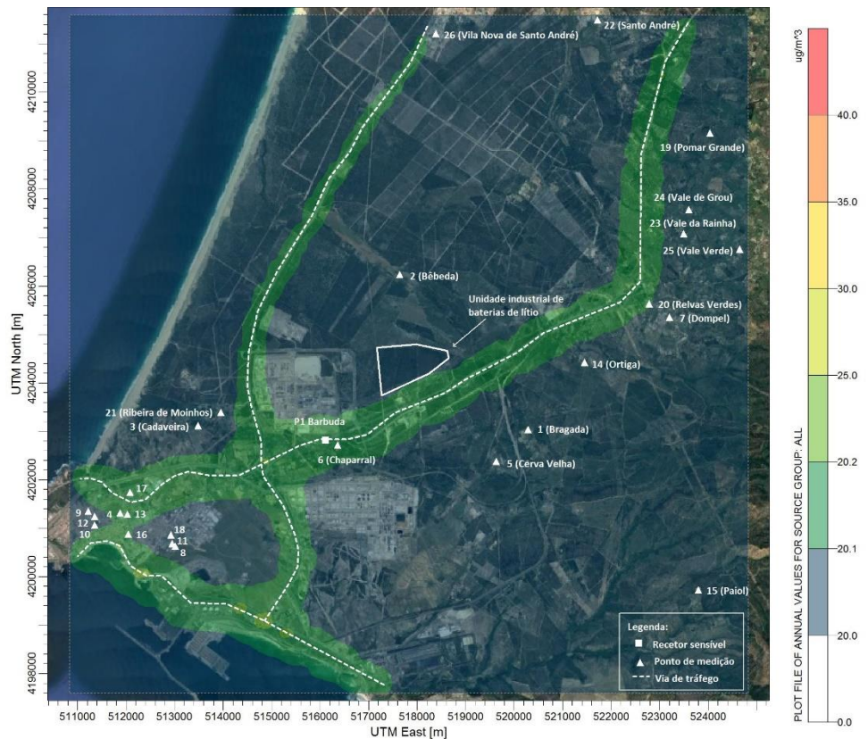
Figura 4.69 - Campo estimado das concentrações médias anuais de PM10 ( \mu\text{g}\cdot\text{m}^{-3} ) verificadas no domínio em análise (situação atual)
