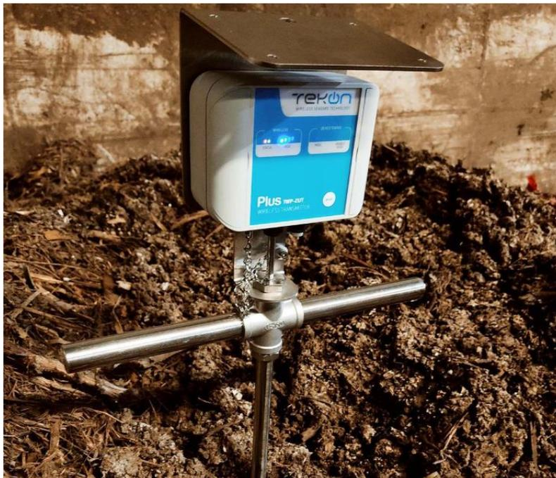
Cada 1 dos 17 Sistema de Leitura de Temperatura + 17 Sistema de Leitura de Oxigênio, estarão em comunicação continua com um sistema de supervisão e controlo que permitirá controlar os parâmetros do processo em cada fase.
