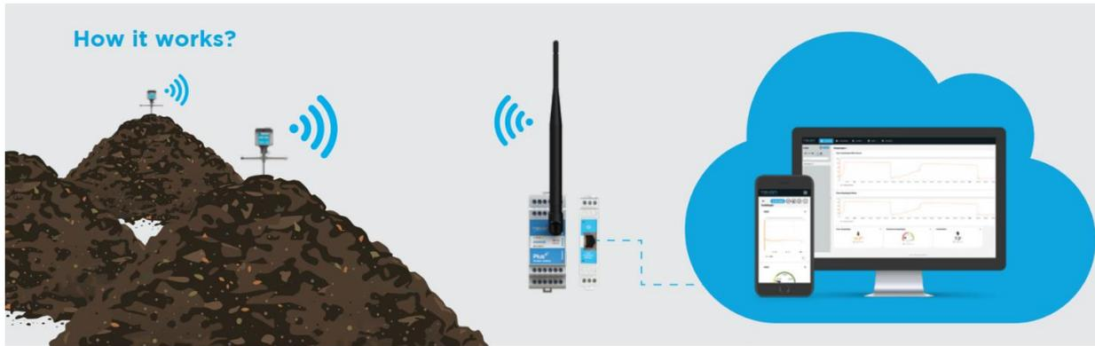
A transmissão de informação entre as sondas e o receptor será efetuada por Wireless, por aplicação de 17 transmissores Wireless, conforme imagem abaixo.
