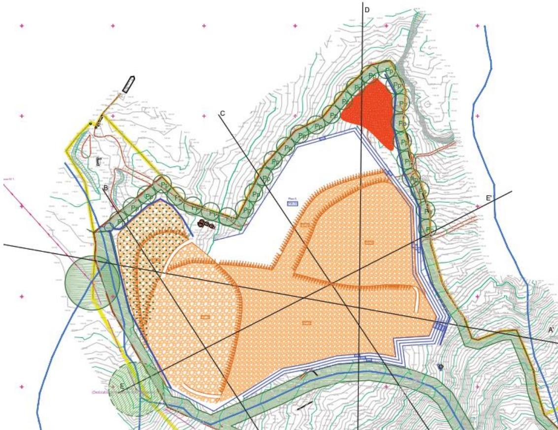
Figura 22. Configuração da escombreira, no final da exploração.
