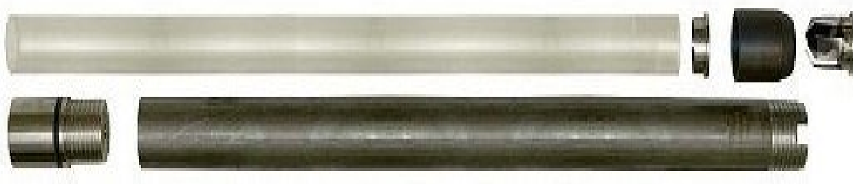
Figura 3 – Amostrador de cravação “direct-push”, com “liner” translúcido
