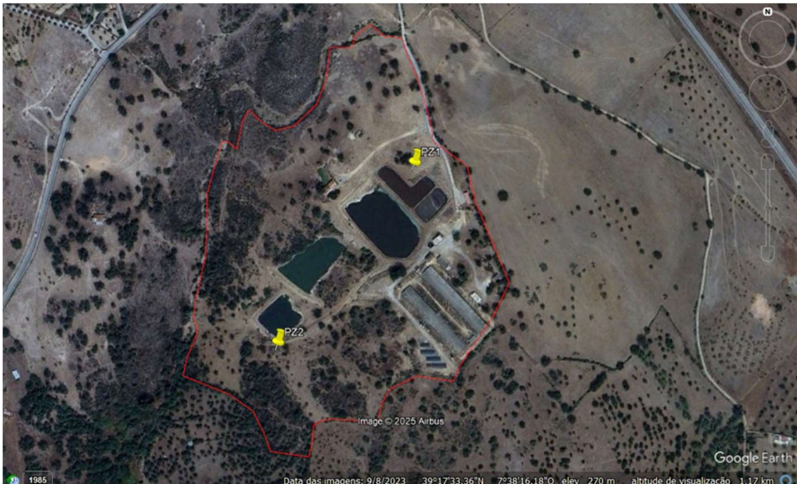
Figura 8 – Proposta de localização de construção de piezómetros.
