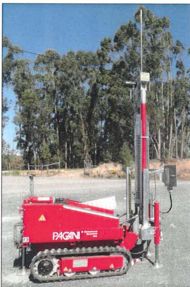
Foto 3 – Máquina Pagani TG63-100 utilizada nas sondagens DPSH.
