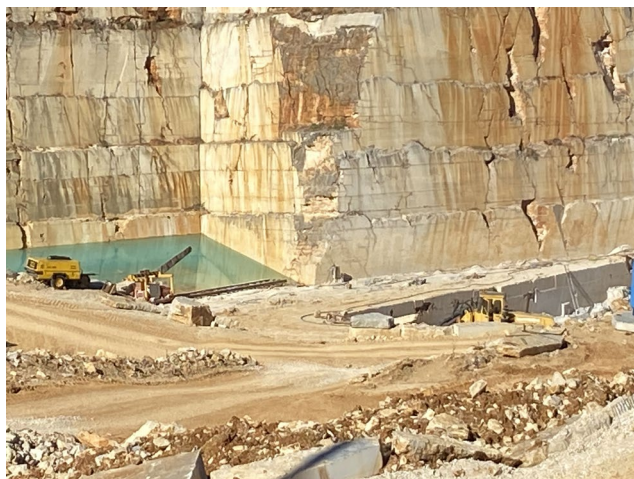
Foto 3 – Vista parcial do fundo da corta de exploração, com a formação em rebaixo de um recetor natural de águas pluviais para utilizar nos trabalhos de desmonte.
