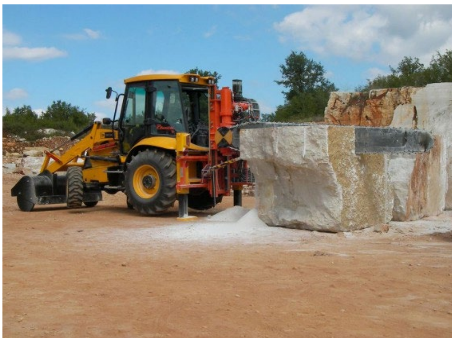
Figura 22 - Corte pelo serrote de lança mais curta para aparelhar o bloco.
