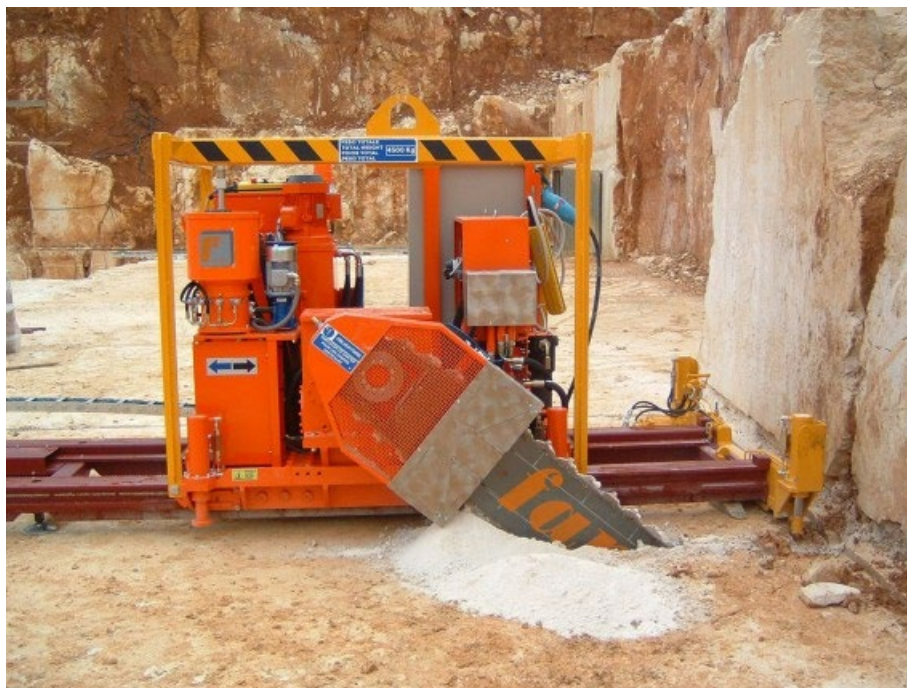
Figura 21 – Corte em bancada pelo serrote de lança mais comprida. Corte lateral da face perpendicular à face livre.
