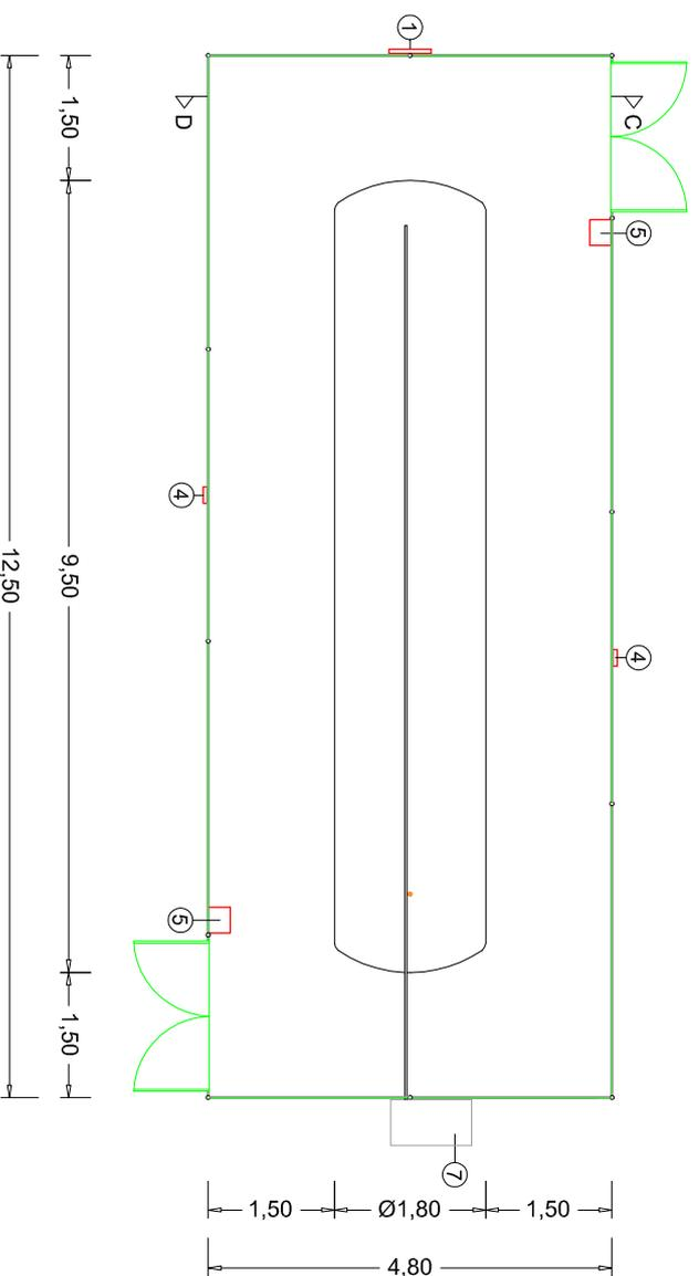
**NOTA:** . Vedação em rede metálica tipo DIN de malha igual ou inferior a 50mm, com um diâmetro mínimo do arame de 2mm, soldados a postes tubulares ou fixos a pilares de betão. A vedação deve possuir duas portas metálicas, de duas folhas, com abertura para o exterior equipadas com fecho não autoblocante, localizadas em lados opostos e de largura mínima de 0,9m por folha. Altura da vedação de 2m
