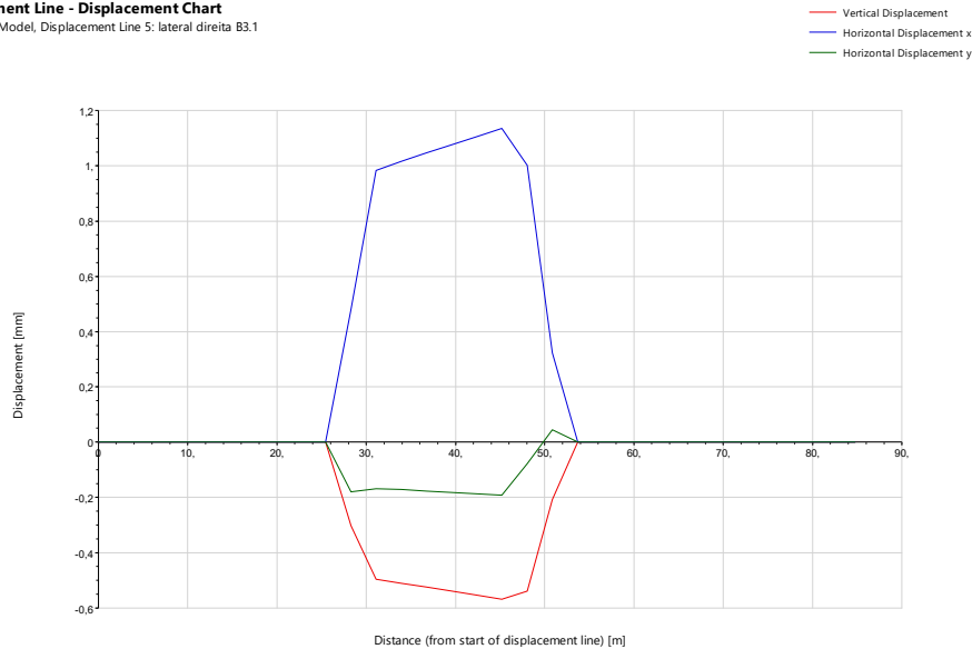
Figura 146 - Caneiro, campo de deslocamentos na lateral direita
