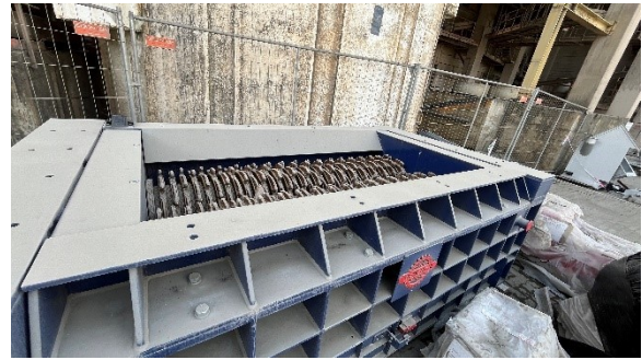
Britador de argila crua, ainda não instalado
