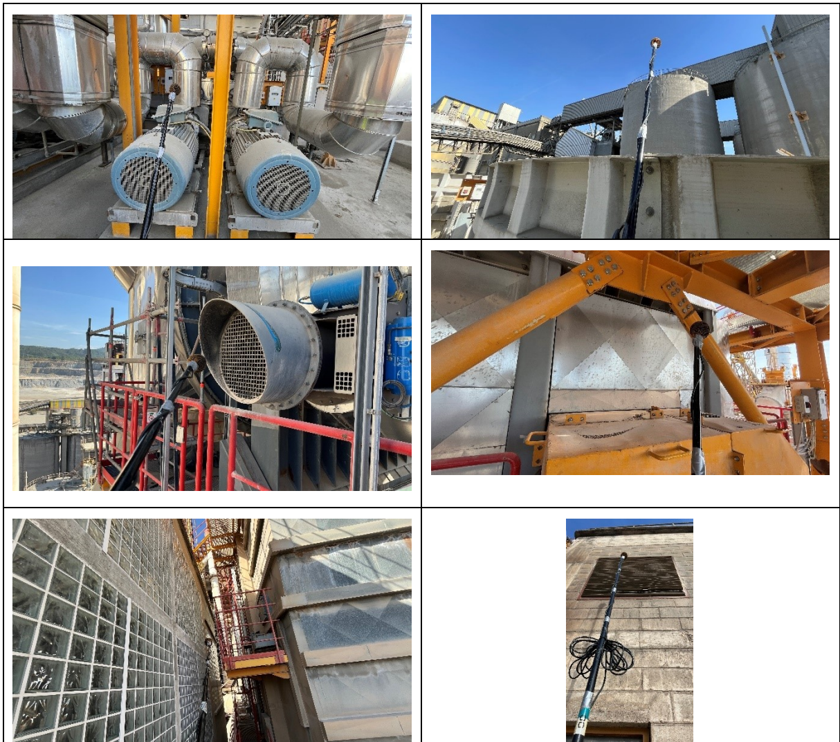
Figura 4-2 – Exemplos das medições de ruído para caracterização das fontes em campo próximo
