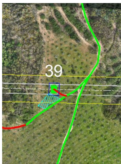
Figura 3.68 – Acesso ao apoio P39
