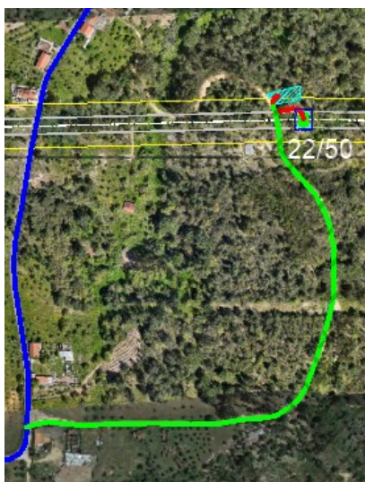
Figura 3.38 – Acesso ao apoio P22/50
