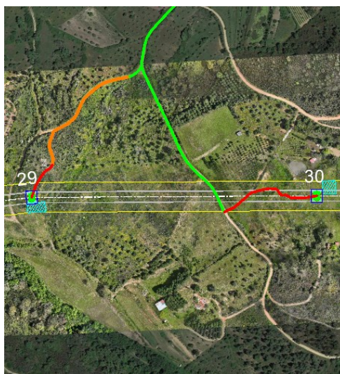
Figura 3.53 – Acessos aos apoios P29 e P30
