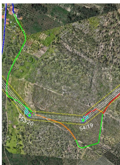
Figura 3.94 – Acessos aos apoios P53/20 e P54/19
