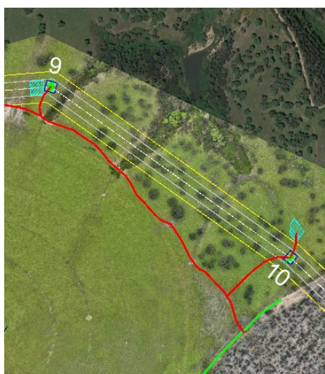
Figura 3.16 – Acesso aos apoios P9 e P10
