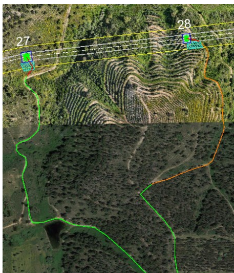
Figura 3.49 – Acessos aos apoios P27 e P28
