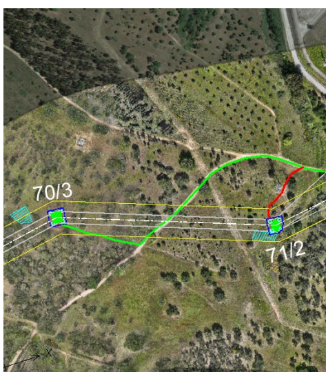
Figura 3.121 – Acesso aos apoios P70/3 e P71/2
