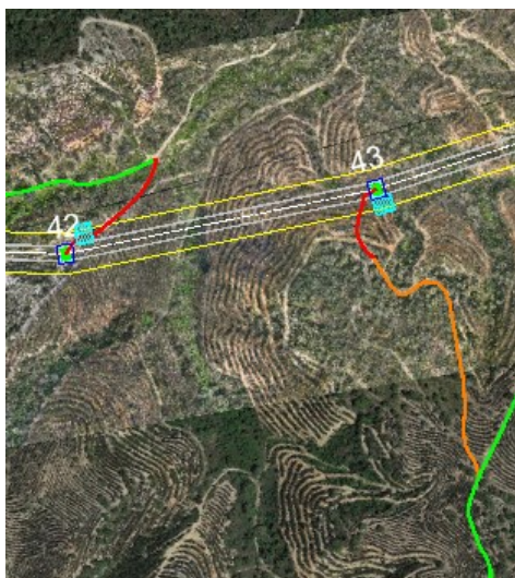
Figura 3.75 – Acessos aos apoios P42 e P43
