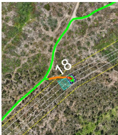
Figura 3.31 – Acesso ao apoio P18
